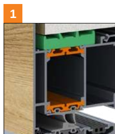
HÁROMKAMRÁS 77 MM MÉLY PROFILOK HŐTÁVTARTÓKKAL
