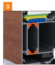
3 60 MM MÉLY HÁROM- KAMRÁS PROFILOK HŐTÖRÉSSSEL
